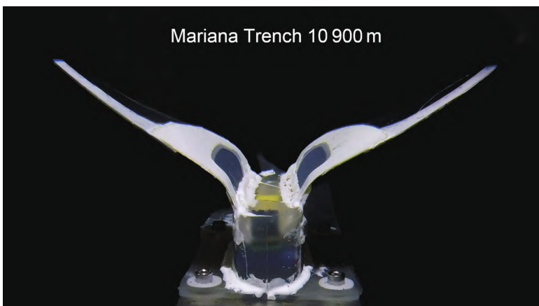
自供电软机器人在马里亚纳海沟10900 m深海驱动实验
